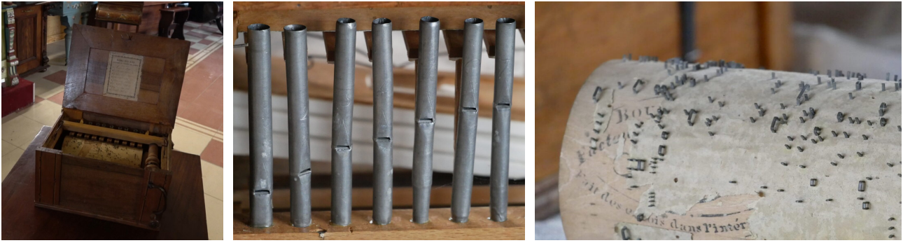
Figure 2 – La serinette (a), destinée à apprendre des airs aux oiseaux, est composée d’un soufflet en bois et en cuir qui transmet de l’air à des petites flûtes en étain (b). Chaque flûte correspond à une note, et la serinette à environ une dizaine de flûtes. Les flûtes sont commandées par un cylindre en bois avec des clous (c). Chaque clou vient ouvrir une soupape qui envoie de l’air dans une flûte. La manivelle vient actionner le soufflet et met en rotation le cylindre. Le morceau est fini après une rotation du cylindre. Il est possible de décaler le cylindre latéralement, ce qui permet de changer les clous qui commandent les flûtes et donc d’avoir huit airs sur un seul cylindre. Les airs sont des musiques populaires d’époque, indiquées par une feuille affichée sur le couvercle de l’instrument.
