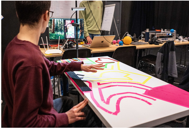
Figure 5. Participant explorant le premier prototype. L'écran au fond montre la détection de la main en direct du point de vue de la caméra.
