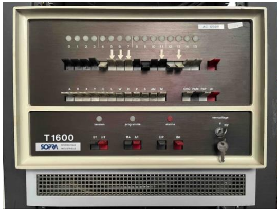
Figure 1. Face avant de l'ordinateur Télémécanique T1600 [© DR – Collections du musée de l'ACONIT].
