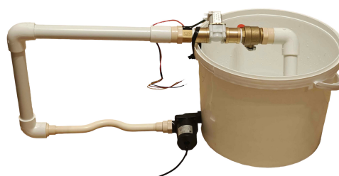
Rysunek 4.7: Testowy układ wodny. Górna część układu jest elementem systemu i służy do pomiaru oraz kontroli przepływu wody.
