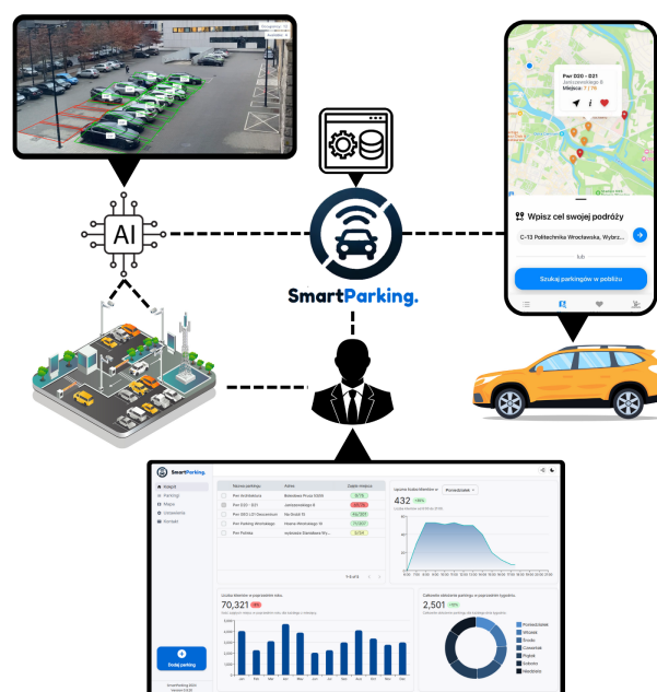
Rysunek 1: Uproszczony schemat systemu Smart Parking [4]
