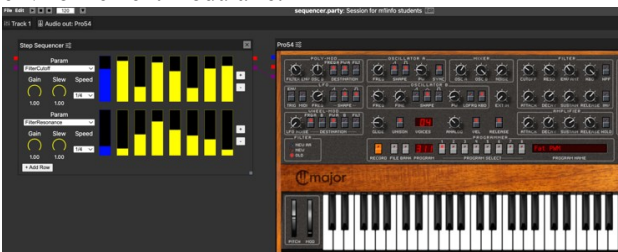
Figure 4 : câblage typique de sequencer.party , un step sequencer WAM (à gauche) modulant certains paramètres de filtre d'un synthétiseur WAM.
